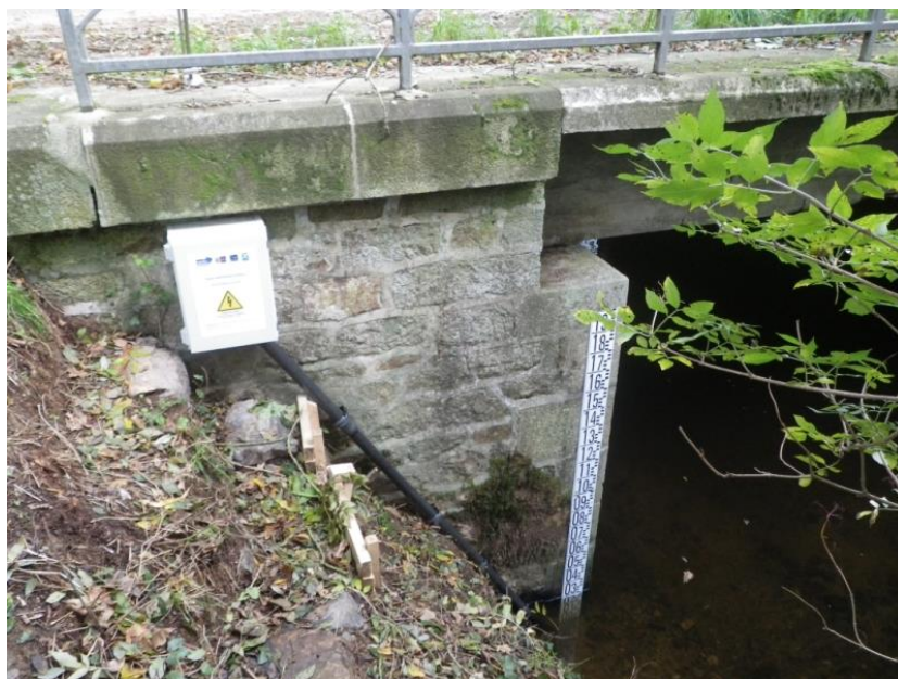
Figure 7 : Appareillages et échelle limnimétrique de la station hydrométrique du Ris ó EPAB 2013
