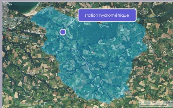
Les débits moyens journaliers sont exprimés en litre par seconde. Ils sont calculés à partir des hauteurs d'eau mesurées à pas de temps régulier par la station hydrométrique puis extrapolées au moyen de la courbe de tarage
