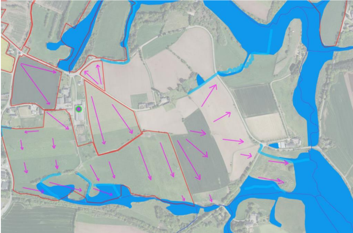
Illustration n°8 : schématisation des cheminements des écoulements dans un paysage agricole de la baie de Douarnenez
